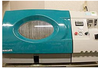
メーカー: ascott 品名: Salt Spray Corrosion Test Chambers (塩水噴霧腐食試験機) モデル: Standard Chambers S120s
