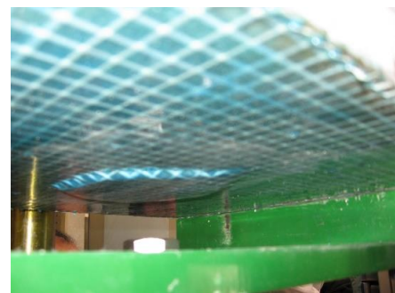
変位量が10mmで1.75kN/mmなので規格値クリア。
