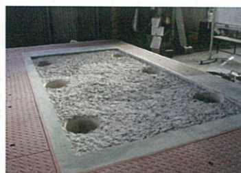
チッピング完了(深さ約30mm)
